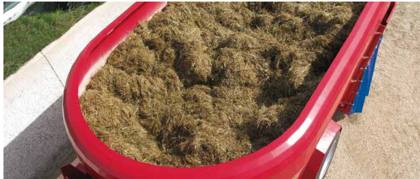
Der abgerundete FlowPlus-Behälterring führt das Futter von oben wieder zurück in den Mischvorgang und sorgt so für verstopfungsfreies Arbeiten, auch bei der Verarbeitung von Rundballen.
