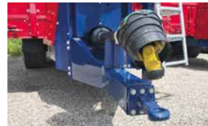
Weitwinkelgelenkwelle und Unten-anhängung
