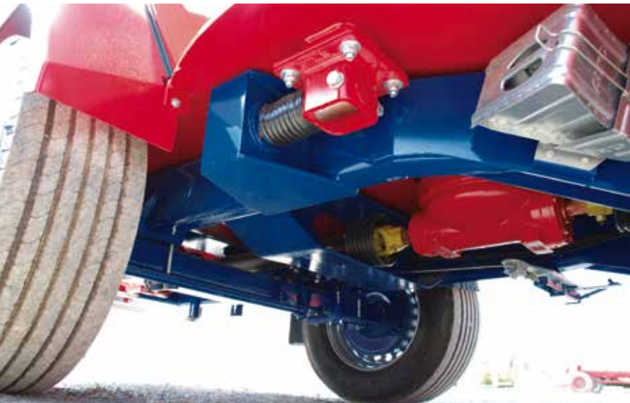
Die großvolumige Bereifung ist passgenau in der Behältertaille angebracht.
