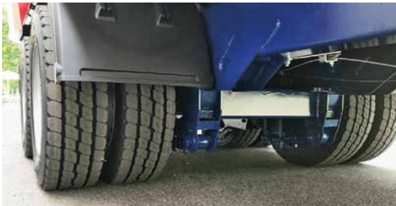
Heavy-Duty-Tandemaggregat 32 t mit Zwillingbereifung für den Einsatz nur auf dem Betriebsgelände (optional).
