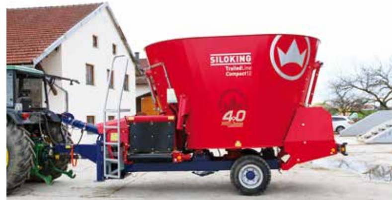
Querförderband vorn und Austragsschieber hinten mittig.
