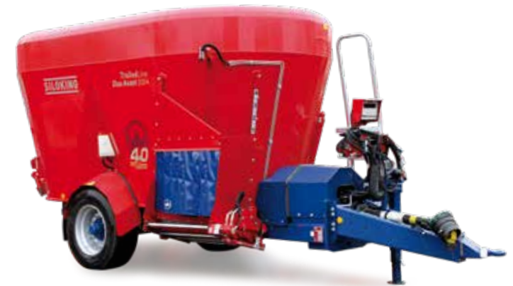
Austragsschieber vorn rechts inkl. ausfahrbarer Austragsförderkette (optional).
